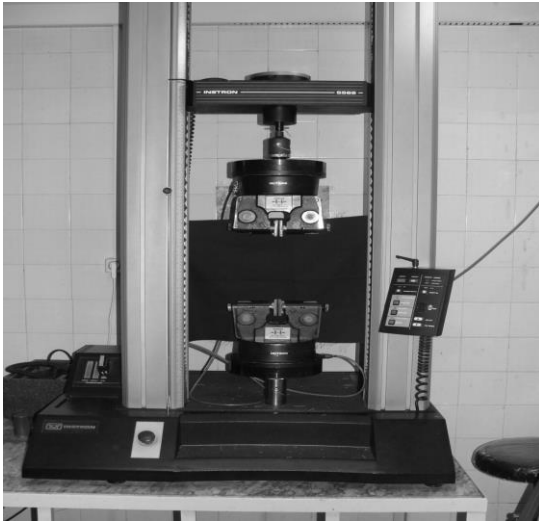
شکل ۲: دستگاه اینسترون موجود در دانشگاه صنعتی امیرکبیر
