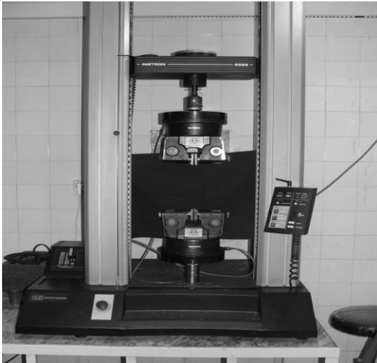
شکل ۲: دستگاه اینسترون موجود در دانشگاه صنعتی امیرکبیر
