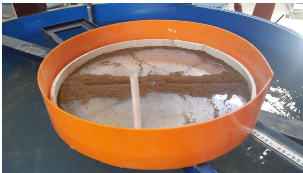
شکل ۳: وسیله توزیع رسوب در مخزن استوانه ای Figure 3: Sediment spreading equipment in cylindrical tank
