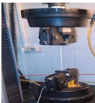
شکل ۳: دستگاه اینسترون مورد استفاده در بررسی استحکام سنجی رشته نخ‌ها Figure 3: Instron testing machine used in study strength length of yarns
