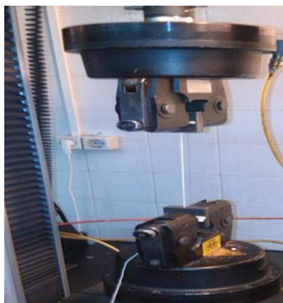
شکل ۳: دستگاه اینسترون مورد استفاده در بررسی استحکام سنجی رشته نخ‌ها Figure 3: Instron testing machine used in study strength length of yarns
