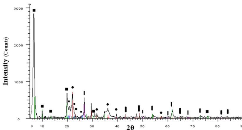
شکل ۲: بررسی نتایج حاصل از XRD نمونه بنتونیت اصلاح شده توسط سورفکتانت
