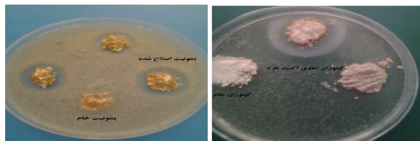
شکل ۵: هاله عدم رشد ترکیبات بنتونیت اصلاح شده با سورفکتانت کاتیونی (سمت چپ) و کیتوزان حاوی اکسید نقره (سمت راست) علیه باکتری یرسینیا راگری
