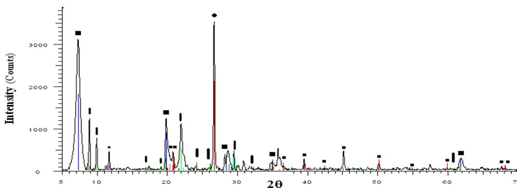
شکل ۱: بررسی نتایج حاصل از XRD نمونه بنتونیت منطقه دیهوک طبس
