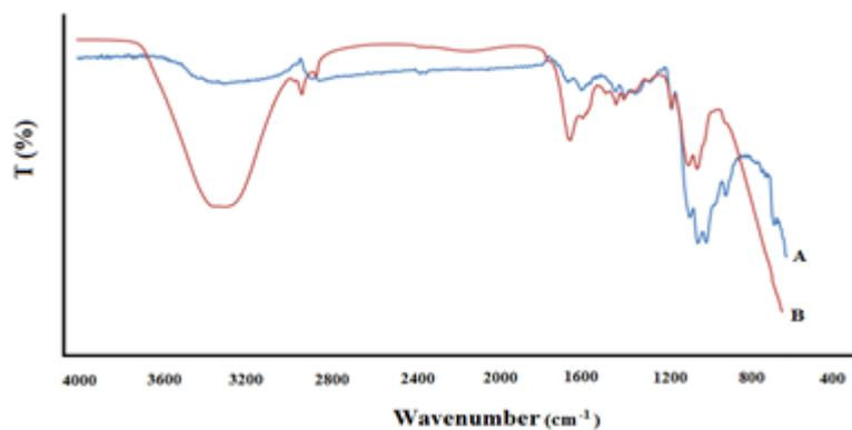
شکل ۴: طیف FTIR مربوط به کیتوزان خام و کمپوزیت کیتوزان حاوی اکسید نقره
