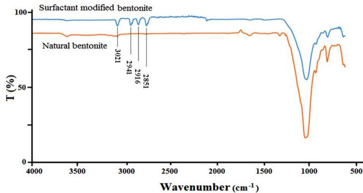
شکل ۳: طیف FTIR بنتونیت خام و بنتونیت اصلاح شده با سورفکتانت کاتیونی
