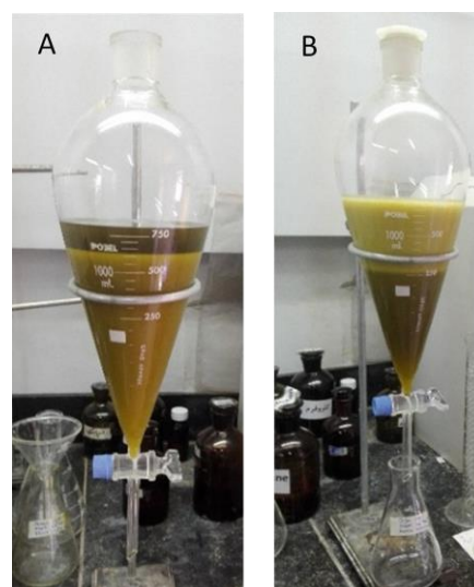
شکل ۱: جداسازی به روش مایع-مایع؛ بخش هگزانی (A)، بخش دی کلرومتانی (B)
