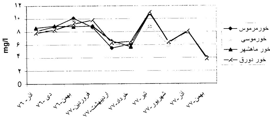
نمودار ۴: میزان اکسیژن محلول آب ایستگاههای نمونه برداری شده (خورموسی ۱۳۷۷ - ۱۳۷۶)
