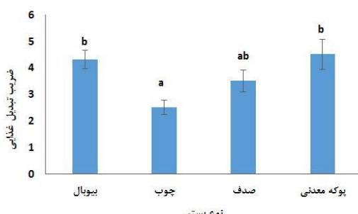
شکل ۳: مقایسه ضریب تبدیل غذایی ماهیان پرورش یافته در سیستم مدار بسته طراحی شده با بسترهای مختلف
