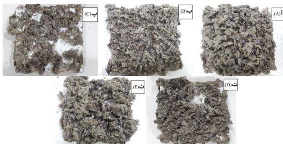
شکل ۱: فولینگ تجمع کرده بر پنل‌ها در پایان دوره آزمایش. آ: پنل بدون پوشش، ب: پنل کنترل، پ: پنل آنتی‌فولینگ ۱، ت: پنل آنتی‌فولینگ ۲، ث: پنل آنتی‌فولینگ ۳.
