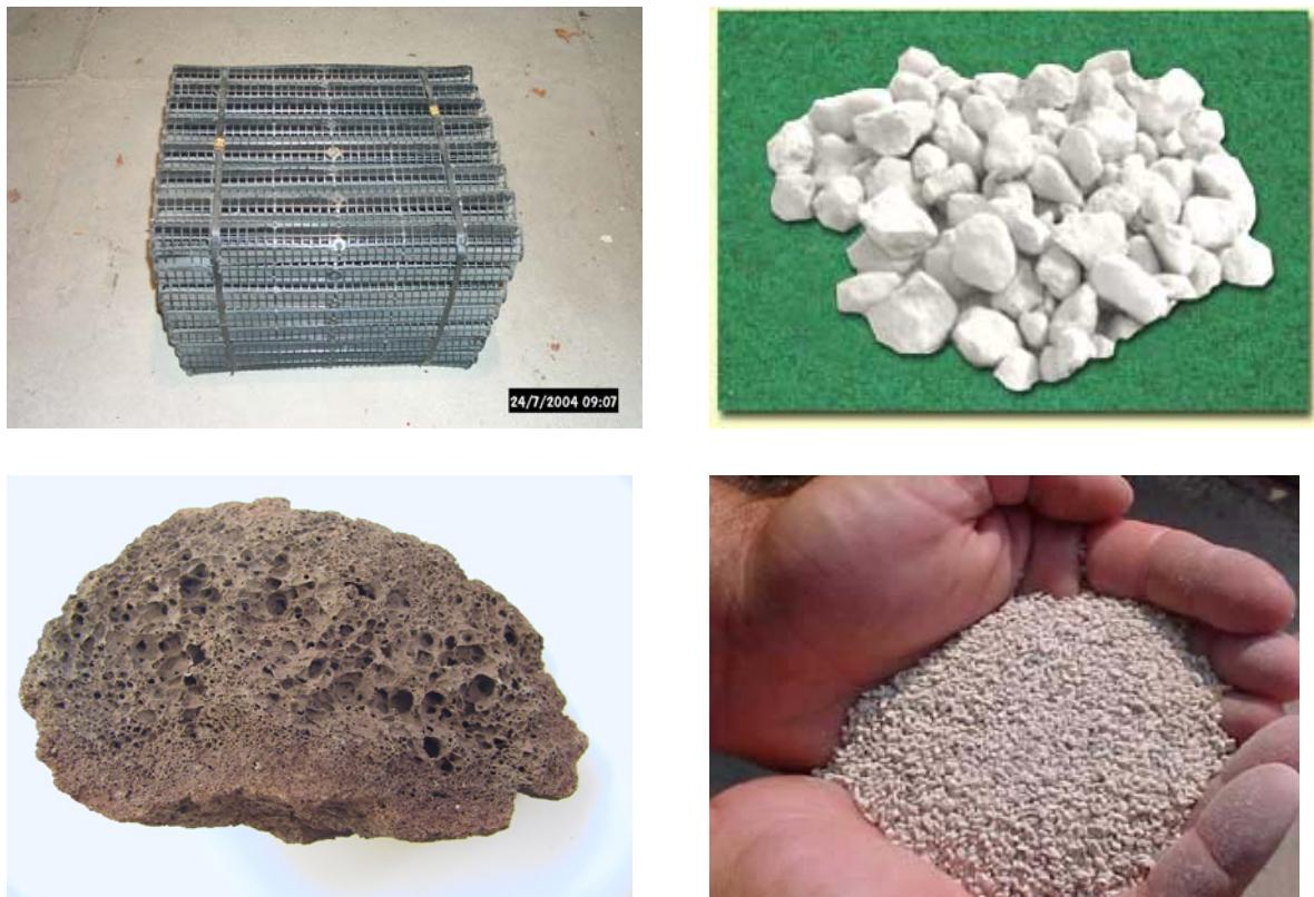
شکل ۱: بتریب بالا از چپ، P.V.C، سنگ مرمر (marble)، پایین از چپ سنگ آذرین (scoria)، سنگ زئولیت (zeolite)
