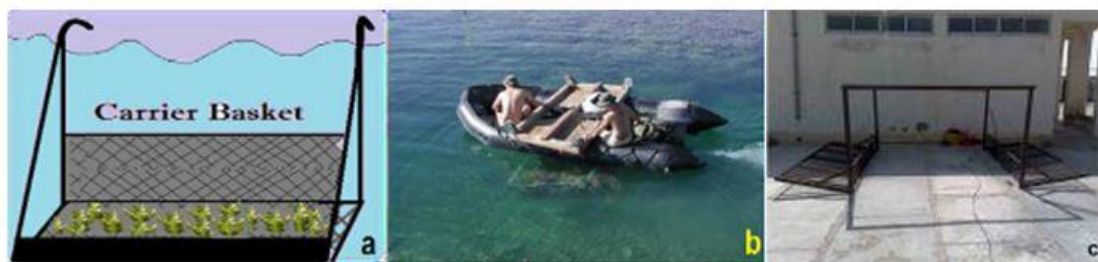
شکل ۲: سبد قدیمی انتقال مرجان (a و b) اقتباس از هاوایی (Carrier Basket) (Paul et al., 2005) و ساخته شده توسط کارشناسان موسسه تحقیقات علوم شیلاتی کشور در مرکز تحقیقات شیلاتی چابهار (c)
