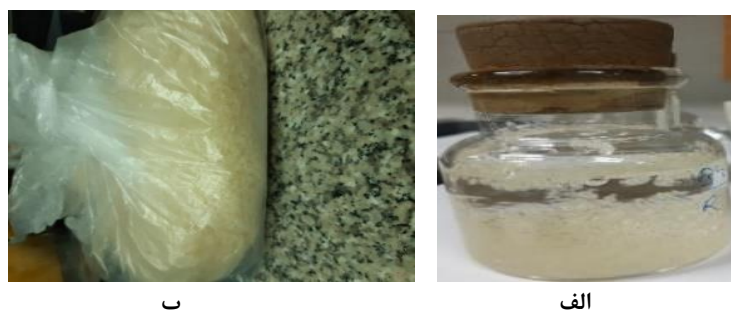
شکل ۲: حالت‌های مختلف یک نمونه ژلاتین گاوی (الف) پودر ژلاتین، (ب) ژلاتین متورم شده Figure 2: Different shapes of bovine gelatin sample (a) gelatin powder, (b) swollen gelatin
