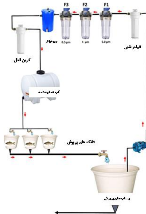
شکل ۱: نمایی شماتیک از سیستم مدار بسته طراحی شده Figure 1: Schematic view of the designed RAS system
