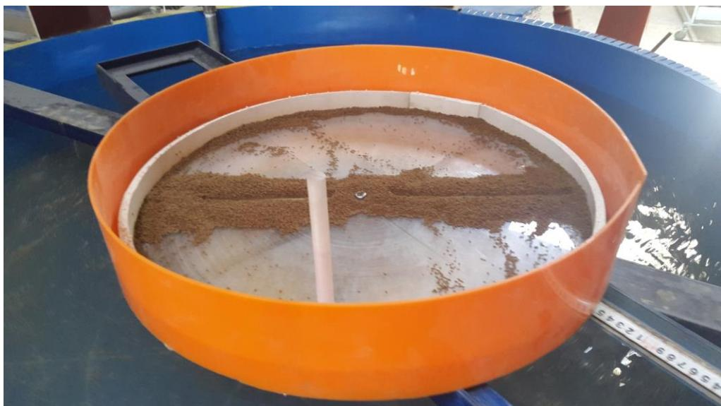
شکل ۳: وسیله توزیع رسوب در مخزن استوانه‌ای
