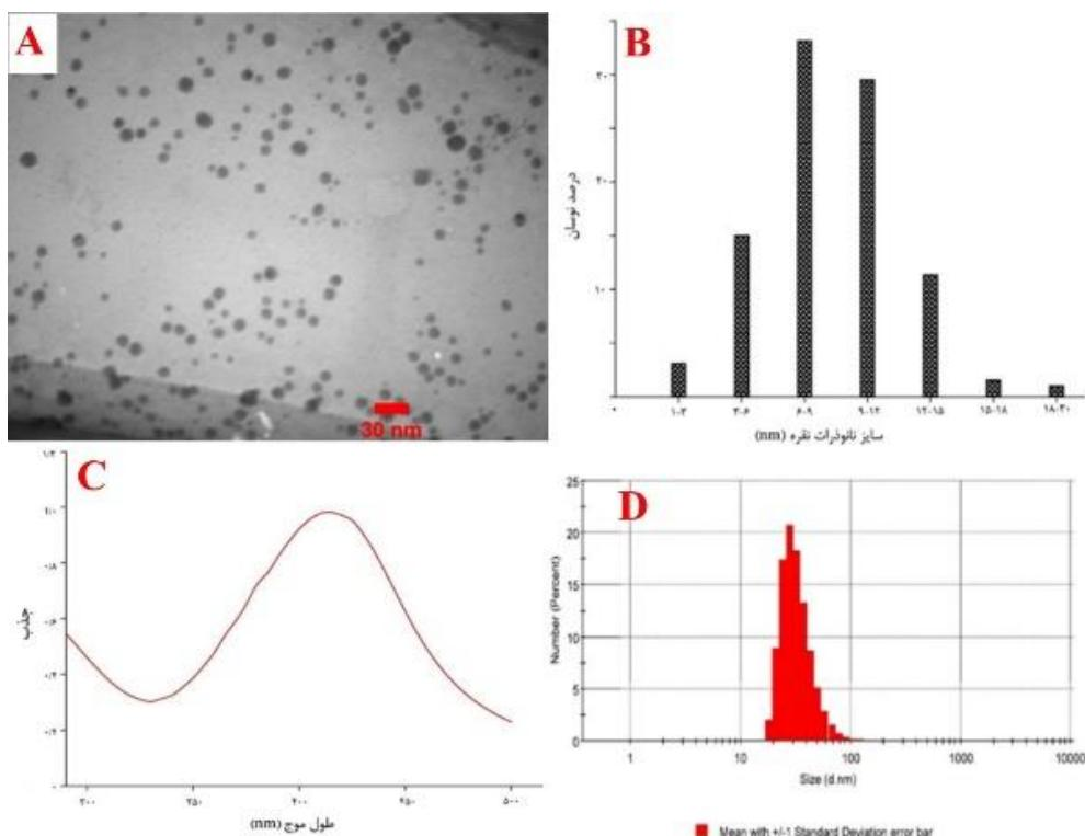
شکل ۱: مشخصات نانوذرات نقره استفاده شده در تحقیق: تصویر میکروسکوپ الکترونی عبوری (TEM) نانوذرات نقره (A)، توزیع سایز بروگفته از تصویر TEM (B)، جذب نوری در محدوده ۲۰۰-۵۰۰ نانومتر (C) و توزیع میانگین سایز هیدرودینامیک (D)
