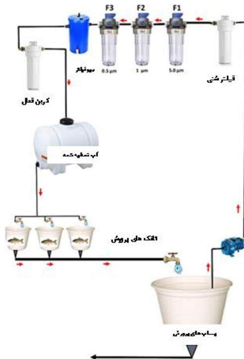
شکل ۱: نمایی شماتیک از سیستم مدار بسته طراحی شده
