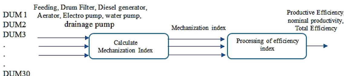
شکل ۱: مدل چند ورودی-چندخروجی برای تحلیل داده‌های مزارع
